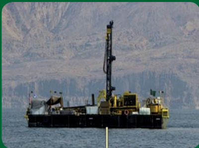
אסדת הקידוח של ארגון DOSECC במרכז ים המלח. באזור זה נקדה גלעין באורך של 460 מטר
